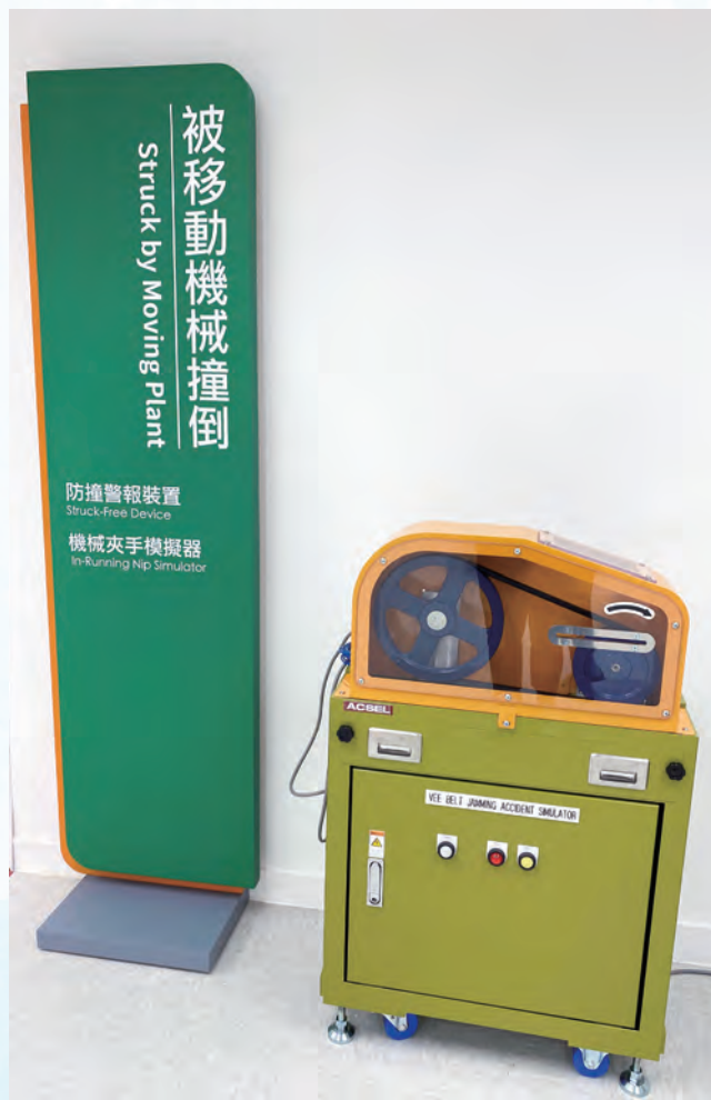
中心內的機械夾手模擬器。 The In-Running Nip Simulator at the training centre.
