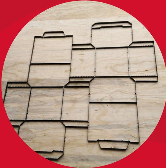
Es un **molde** que se usa para la fabricación de una caja **troquelada**, la cual lleva generalmente **ventilaciones** con ciertas **características especiales**.
