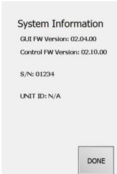
I campi "GUI FW Version" e "Control FW Version" indicano la versione del firmware installata nel dispositivo.
