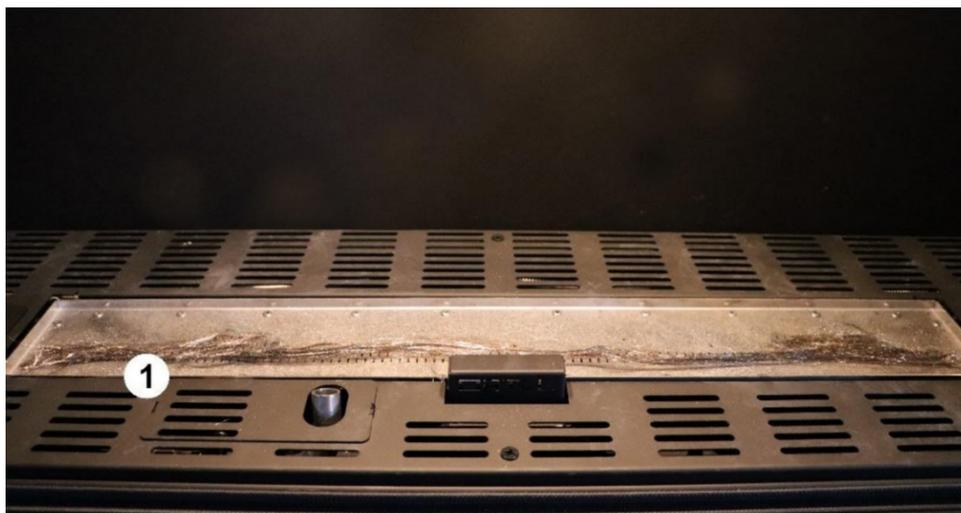
**⚠ AVERTISSEMENT :** Pour plus de sécurité et un fonctionnement optimal du foyer, maintenez un pouce autour du pilote (derrière le capot du pilote) complètement à l'écart de tout support ou débris.
