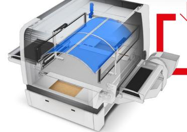
THE AIR FED THROUGH THE DELIVERY PLENUM PUSHES THE OVERSPRAY UP TO THE BELT AND FILTER SYSTEM INCREASING THE TRANSFER EFFICIENCY SIGNIFICANTLY
