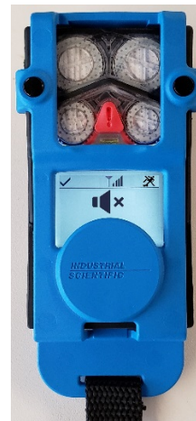
Ventis Pro com Standby Clip (operador incapacitado e leituras de gás em standby)
