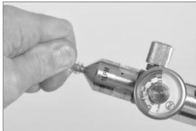
Empurre e encaixe a mangueira no bico do regulador, conectando-os firmemente.
