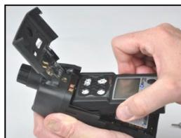
Coloque o instrumento na caixa da bomba; aperte\* os quatro parafusos torx na parte traseira da bomba.
