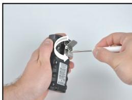
Desparafuse e remova a presilha do cinto. Guarde a presilha, o parafuso e a arruela para uso posterior.
