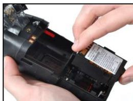
Instale uma bateria com faixa estendida compatível (lado do rótulo para cima) no encaixe inferior da caixa da bomba.
