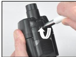
Abaixe a tampa da bomba. Deslize-a até ouvir um som de "clique" indicando que está totalmente fechada. Aperte\* o parafuso da tampa da bomba.
