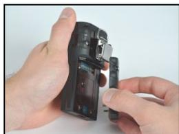
Desparafuse, levante e remova a bateria do instrumento de difusão e guarde-a para uso posterior.
