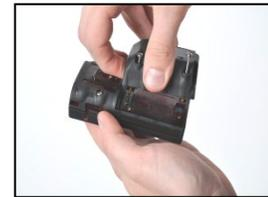
Usando uma chave de fenda torx, solte os quatro parafusos da bateria (esquerda) ou da tampa da bateria (direita).
