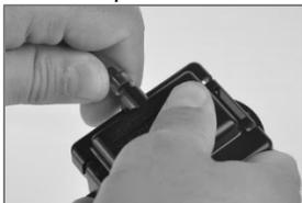
Empurre e encaixe a mangueira no bico do copo de calibração, conectando-os firmemente.
