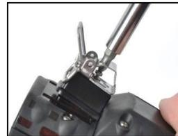
Para remover a presilha, use uma chave de fenda Torx para acessar o parafuso. Gire no sentido anti-horário para soltar o parafuso.
