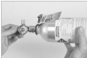
Segure o regulador (fluxo positivo mostrado) e gire o cilindro de gás de calibração para a direita, de modo a apertar o regulador.
