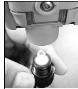
Inverta o instrumento. Coloque o novo filtro interno no cilindro de entrada do módulo da bomba.
