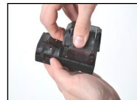
Lockern Sie alle vier Schrauben mit einem Torx-Schraubendreher an der Batterie (links) oder der Batterieabdeckung (rechts).
