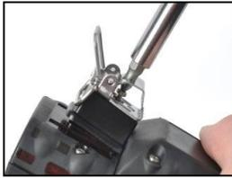
Zum Entfernen der Klemme einen Torxschraubendreher verwenden, um auf die Schraube der Klemme zuzugreifen. Nach links drehen, um die Schraube zu lockern.
