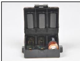
1. Entriegeln Sie den am Scharnier befestigten Teil des Batteriefachs und heben Sie ihn ab.
