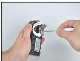
Schrauben Sie die Gürtelklemme auf und nehmen Sie sie ab. Heben Sie die Klemme, die Schraube und die Unterlegscheibe zur späteren Verwendung auf.
