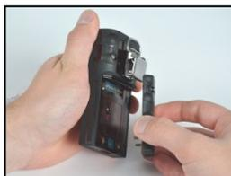
Drehen Sie die Batterie und heben Sie sie aus dem Batteriefach des Diffusionsgerätes heraus. Heben Sie sie zur späteren Verwendung auf.
