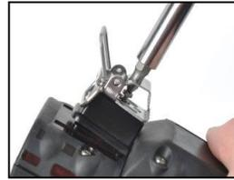
Setzen Sie die Schraube in das Loch des Abstandhalters und unten in das Gehäuseunterteil.
