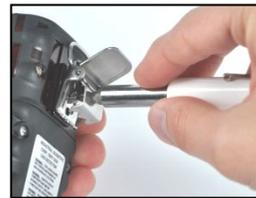
Zum Befestigen der Klemme, die Unterlegscheibe auf die Schraube legen, und die Schraube in das mittlere Loch der Klemme einsetzen.
