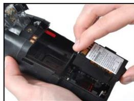
Installieren Sie eine kompatible Batterie mit längerer Laufzeit—Etikett nach oben—in das untere Fach im Pumpengehäuse.
