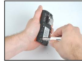
Ziehen Sie die vier Schrauben mit einem Torx-Schraubendreher fest\*, um die Batterie (s. Abb.) oder die Batterieabdeckung am Gerät zu sichern.
