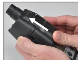
Klappen Sie die Pumpenklappe herunter und schieben Sie sie in die ganz geschlossene Position. Ein Klicken bestätigt den richtigen Verschluss.
