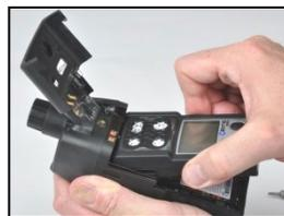
Legen Sie das Gerät in das Pumpengehäuse; ziehen Sie die vier Torx-Schrauben hinten an der Pumpe fest.\*
