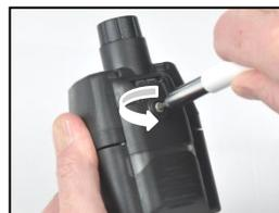
Lockern Sie die Schraube an der Pumpenklappe.
