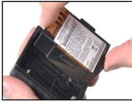
Zur Installation der Batterie mit längerer Laufzeit, legen Sie zunächst die Batterie in die Batterieabdeckung. Bei richtiger Platzierung ist das Etikett der Batterie zu sehen.
