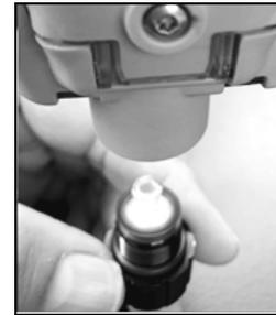
Das Gerät umdrehen. Den neuen Filter in die Einlassröhre des Pumpenmoduls einsetzen.
