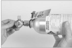
Den Regler (einstellbarer Regler gezeigt) festhalten und die Kalibriergasflasche zum Anziehen im Uhrzeigersinn drehen.
