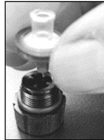
Den Ersatzfilter in die Filterkappe (Filter T/N 17058157 abgebildet) einsetzen.
