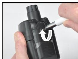
Klappen Sie die Pumpenklappe herunter und schieben Sie sie in die ganz geschlossene Position, bis ein Klicken ertönt. Ziehen Sie die Schraube an der Pumpenklappe fest.\*
