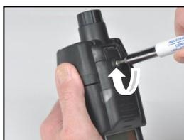
Ziehen Sie die Schraube an der Pumpenklappe fest.\*
