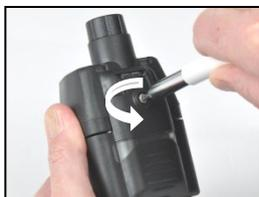
Lockern Sie die Schraube an der Pumpenklappe. Schieben Sie die Pumpenklappe nach unten; heben Sie sie an, um sie zu öffnen.
