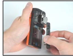
Richten Sie die Batterie mit dem Gerät aus, um sie zu installieren.
