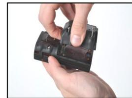
Use un destornillador Torx para aflojar los cuatro tornillos de la batería (izquierda) o la cubierta de la batería (derecha).
