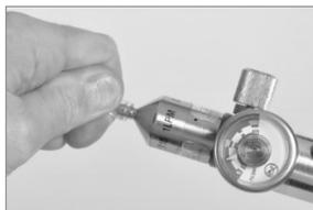
Empuje el tubo sobre la boquilla del regulador de modo que encaje de forma apretada.
