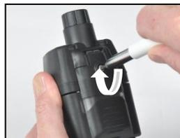
Baje la puerta de la bomba. Deslícela a su posición completamente cerrada hasta hacer clic. Apriete\* el tornillo de la puerta de la bomba.
