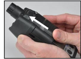
Baje la puerta de la bomba. Deslícela a su posición completamente cerrada hasta hacer clic.
