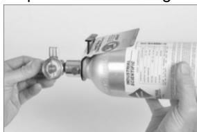
Sujete el regulador (se muestra el caudal positivo) para girar el cilindro de gas de calibración hacia la derecha para apretar.
