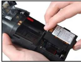
Instale una batería de larga duración compatible, con la etiqueta apuntando hacia arriba, en el receptáculo inferior de la caja de la bomba.
