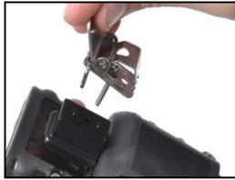
Para sujetar la presilla y el espaciador, cubra la plataforma de la parte inferior de la caja con el espaciador.
