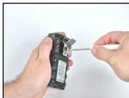
Para quitar la presilla, use un destornillador Torx para aflojar el tornillo de la presilla. Gire hacia la izquierda para aflojarlo.
