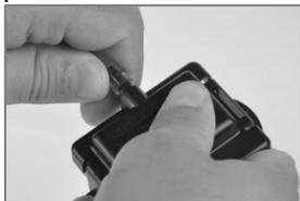
Empuje el tubo sobre el niple de la cubeta de calibración de modo que encaje de forma apretada.
