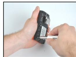
Use un destornillador Torx para apretar\* cada uno de los cuatro tornillos a fin de fijar la batería (mostrada) o la cubierta de la batería al instrumento.
