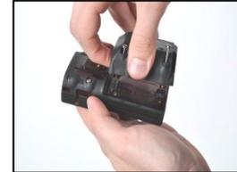
A l'aide d'un tournevis étoile, desserrer les quatre vis de la pile (à gauche) ou du couvre-pile (à droite).
