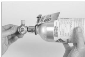
Tout en maintenant le détendeur (débit positif illustré), tourner la bouteille de gaz d'étalonnage dans le sens des aiguilles d'une montre pour serrer.
