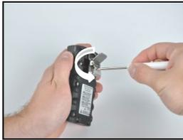
Dévisser et déposer la pince de ceinture. Mettre de côté la pince, la vis et la rondelle pour utilisation ultérieure.
