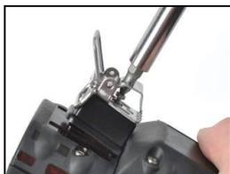
Pour déposer la pince, utiliser un tournevis Torx pour accéder à la vis de fixation de la pince. Tourner dans le sens antihoraire pour desserrer la vis.
