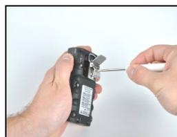
Desserrer la vis de fixation dans le sens antihoraire avec un tournevis Torx pour retirer la pince.
