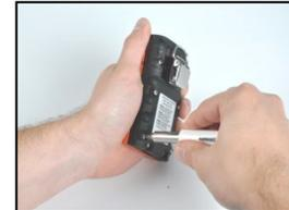
Pour installer la pile à longue durée, la placer d'abord dans le couvre-pile. Lorsque la pile est placée correctement, son étiquette est visible.
