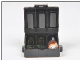
1. Déverrouiller et soulever la portion articulée du compartiment des piles.
