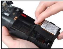
Installer une pile à longue durée compatible – avec l'étiquette sur le dessus – dans le réceptacle inférieur du boîtier de pompe.
