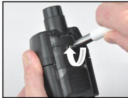
Abaisser la couvercle de pompe. Le faire glisser jusqu'à la position complètement fermée indiquée par un déclic. Serrer\* la vis du couvercle de pompe.
