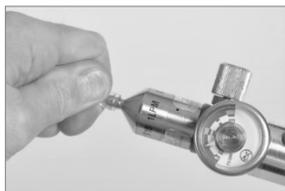
Enfoncer le tube sur la buse du détendeur pour qu'il soit bien ajusté.
