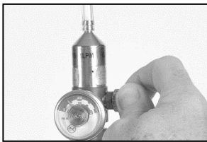
Anzeigetest wird ausgeführt
