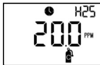
Kalibrierung wird ausgeführt
