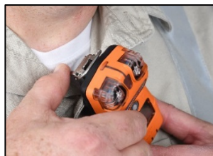
Posicione a roupa entre os dentes superiores e inferiores do clipe. Pressione a tampa do clipe para baixo para prender o clipe no lugar.
