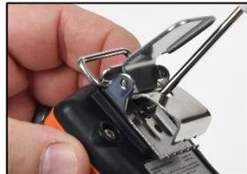
Führen Sie den Schraubendreher durch das Loch des Clips und setzen Sie ihn auf den Kopf der Schraube auf. Zum Festziehen im Uhrzeigersinn drehen.
