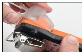
Positionieren Sie den Kalibrierbecher über dem Gehäuseoberteil. Richten Sie die obere Kerbe des Bechers mit der kleinen Erhöhung an der Oberseite des Geräts aus.
