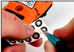
Kratzen Sie leicht über das Papier an der Kante der Wassersperre und heben Sie es leicht an, um einen Teil der klebenden Rückseite freizulegen. Ziehen Sie die Wassersperre ab.
