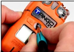
Ziehen Sie mit den Fingern oder mit einer Pinzette die Staubsperre ab und entsorgen Sie sie.
