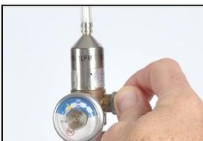
Um den Fluss des Gases zu stoppen, drehen Sie den Hahn des Regulators im Uhrzeigersinn und ziehen Sie ihn fest.
