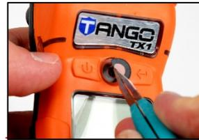
Setzen Sie die neue Wassersperre – mit der Klebeseite nach unten – auf das Gehäuseoberteil, über dem Lautsprecher.
