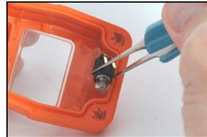
Greifen Sie den neuen Motor vorsichtig mit der Pinzette. Setzen Sie den neuen Motor – mit der Kontaktseite nach oben – in das Gehäuseoberteil ein. Drücken Sie den Motor mit der Pinzette an seine Position und achten Sie dabei darauf, die Kontakte nicht zu berühren.
