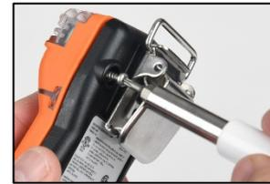
Setzen Sie die vier Schrauben in das Gehäuseunterteil ein und ziehen Sie sie mit einem Torx-Schraubendreher fest.
