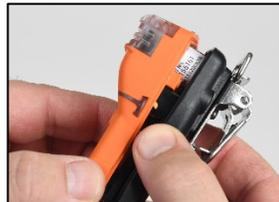
Setzen Sie das Gehäuseoberteil auf das Gehäuseunterteil auf. Führen Sie die Sensoren mit einer geraden Bewegung nach unten in die Hülsen auf der Leiterplatte ein.
