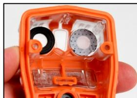
Entfernen Sie die Rückstände von Klebstoff, Filter oder Dichtung. Entfernen Sie Schmutz, Staub oder sonstige Verunreinigungen.
