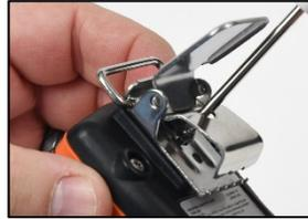
Lösen Sie die Schraube des Clips mit einem Torx-Schraubendreher. Drehen Sie gegen den Uhrzeigersinn, um die Schraube zu lösen und entnehmen.
