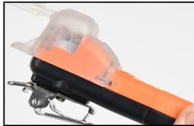
Positionieren Sie den Kalibrierbecher über dem Gehäuseoberteil. Richten Sie die obere Kerbe des Bechers mit der kleinen Erhöhung an der Oberseite des Geräts aus. Drücken Sie nach unten, um den Clip in seiner Position zu sichern. Sie hören einen Klick. Führen Sie eine Sichtprüfung am Kalibrierbecher durch, um sicherzustellen, dass die oberen und seitlichen Kanten mit den Kanten des Gehäuseoberteils ausgerichtet sind.
