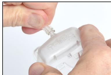
Verbinden Sie das andere Ende der Hülse mit dem Kalibrierbecher. Fahren Sie mit der Anleitung unten für die gewünschte Aufgabe fort: Kalibrierung oder Bump-Test.
