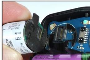
Positionieren Sie den Sensor so, dass sein Anschluss mit der Platine übereinstimmt.
