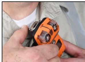
Klemmen Sie das Kleidungsstück zwischen den Zähnen des Clips fest. Drücken Sie auf die Abdeckung des Clips, um ihn an seiner Position zu sichern.
