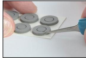
Setzen Sie das Dichtungsblatt auf die Arbeitsoberfläche. Kratzen Sie leicht über das Papier an der Kante des Dichtrings und heben Sie es leicht an, um einen Teil der klebenden Rückseite freizulegen.
