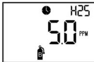
Bump-Test wird ausgeführt
