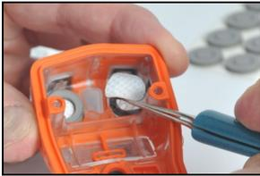
Setzen Sie den neuen Filter – mit der Klebeseite nach unten – auf die Filteröffnung.
