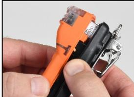
Halten Sie das Geräteunterteil in der Nähe der oberen Schraubenlöcher und heben Sie das Gehäuseoberteil leicht an, um Ober- und Unterseite zu trennen.
