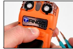
Drücken und halten Sie die Staubsperre mit dem Daumen 5 Sekunden lang gedrückt, um sie festzukleben.
