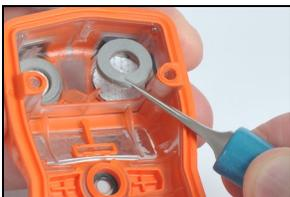
Führen Sie die neue Dichtung – mit der Klebeseite nach unten – in die Filteröffnung ein und setzen Sie sie auf den Filter.
