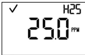
Bevor der nächste Schritt begonnen wird, sollte sich der Gasmesswert stabilisiert haben.
