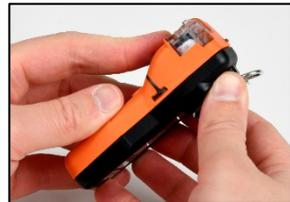
Sichern Sie Gehäuseoberteil und Gehäuseunterteil mit leichtem Druck.
