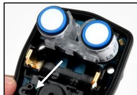
Die innere Stromtaste befindet sich unter der Halterung für die Batterieablage und links vom Lautsprecher (siehe oben). Drücken Sie diesen Knopf und halten Sie ihn zwei Sekunden lang gedrückt, bevor Sie ihn loslassen.
