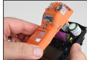
Fahren Sie fort, das Gehäuseoberteil gerade nach oben abzuheben, um es abzunehmen und um ein versehentliches Lösen der Sensoren zu vermeiden. Wenn Sie nur das Gehäuseoberteil austauschen wollen, lesen Sie bitte die Anleitung unten „Demontage des Geräts“. Andernfalls fahren Sie mit den gewünschten Serviceaufgaben unten fort.
