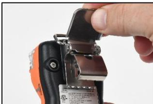
Heben Sie die Abdeckung des Clips an.
