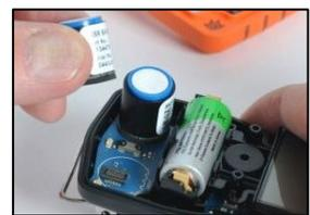
Algunos sensores pueden tener un refuerzo de adhesivo que los sujeta en posición; ejerza una presión ligera para levantar y quitar los sensores. Ponga a un lado para usar en el futuro o deseche, según las normas de la empresa.
