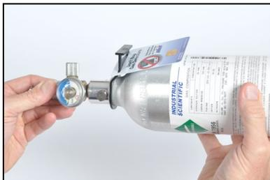
Sostenga el regulador, gire el cilindro de gas de calibración en sentido horario para ajustar.
