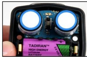
Levante un sensor por los lados para quitarlo (se muestra en la imagen derecha). No toque la parte superior de ningún sensor.
