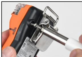
Con un destornillador Torx, quite los cuatro tornillos de la parte inferior de la carcasa, deje los tornillos a un lado.
