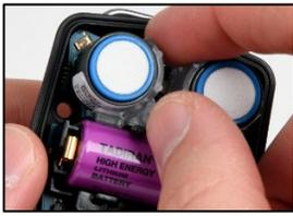
Use el dedo pulgar y el dedo índice para agarrar suavemente las partes superior e inferior del soporte del sensor y quítelo. La parte superior del soporte es más estrecha que la parte inferior.
