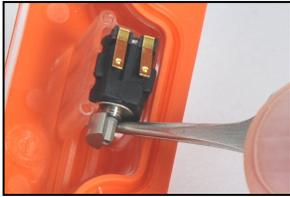
Introduzca las pinzas entre la parte superior de la carcasa y el motor. Haga palanca hacia arriba para retirar.
