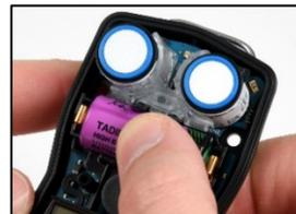
Oriento la batería de repuesto para que los extremos positivo y negativo coincidan con las marcas “+” y “-” del soporte, respectivamente. Coloque la batería nueva en el soporte apoyando primero el extremo negativo. Presione la batería para fijarla en el soporte.
