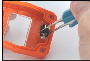
Con las pinzas, sujete suavemente el nuevo motor. Coloque el nuevo motor (con el lado de contacto hacia arriba) dentro de la parte superior de la carcasa. Sin tocar los contactos del motor, utilice el mango de la pinza para presionar y colocar el motor en su lugar.
