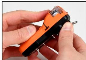
Presione para asegurar la parte superior de la carcasa contra la parte inferior.
