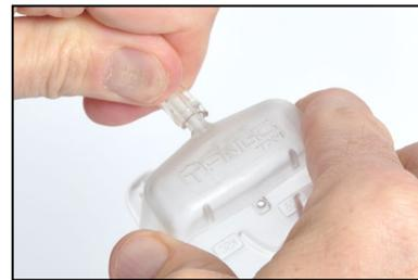
Conecte el otro extremo del tubo al recipiente de calibración. Siga las indicaciones a continuación para realizar la tarea que desee: calibración o prueba funcional.
