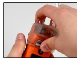
Para eliminar el recipiente de calibración, levante las pestañas del recipiente. Deje a un lado o guarde para usar en el futuro.
