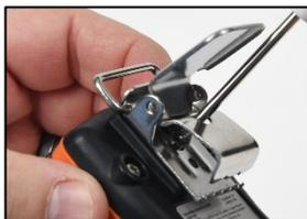
Utilice un destornillador Torx para retirar el tornillo del clip. Gire hacia la izquierda para aflojar y retirar el tornillo.
