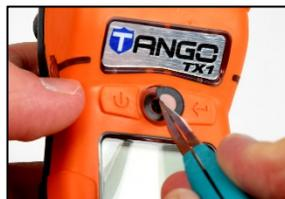
Guíe la nueva barrera (con la parte adhesiva hacia abajo) en dirección a la parte superior de la carcasa, colocada sobre el altavoz.
