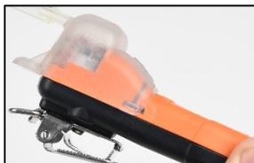
Coloque el recipiente de calibración sobre la parte superior de la carcasa, alinee la ranura superior con el pequeño cordón de la parte superior del instrumento.
