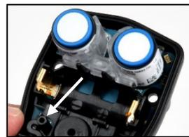
El botón de corriente del interior está debajo del soporte de la batería, a la izquierda del altavoz (vea flecha arriba). Presione sin soltar este botón durante dos segundos y después suéltelo.
