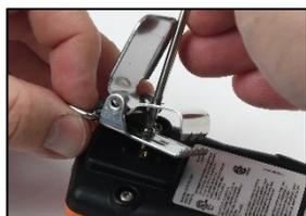
Para colocar la cubierta del clip, coloque el destornillador en el centro del agujero de la parte posterior del clip.
