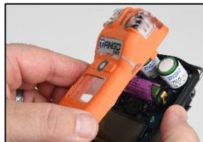
Siga levantando la parte superior de la carcasa para quitarla y evitar aflojar involuntariamente los sensores. Si solo sustituye la parte superior de la carcasa, consulte la tarea siguiente "Ensamblaje del instrumento". De lo contrario, continúe con la tarea de servicio que desea según lo descrito a continuación.
