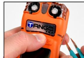
Coloque el pulgar sobre la barrera de polvo y mantenga presionado durante cinco segundos para activar el adhesivo.
