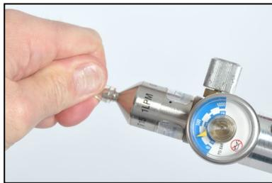
Conecte cualquiera de los extremos del tubo de calibración a la boquilla del regulador.
