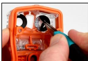
Dentro de la parte superior de la carcasa, sujete el burlete y el filtro de abajo del sensor con las pinzas de punta fina; desprenda para retirar.
