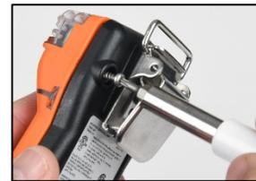
Utilice un destornillador Torx para introducir y ajustar cada uno de los cuatro tornillos a la parte inferior de la carcasa.
