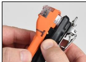
Sostenga la parte inferior de la carcasa cerca de los agujeros para tornillos superiores; levante levemente la parte superior de la carcasa para separar la parte superior de la inferior.
