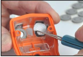
Guíe el nuevo filtro (con el adhesivo hacia abajo) en dirección a la abertura del filtro. Para colocarlo correctamente, procure que el borde del filtro coincida con el borde interior de la abertura del filtro.
