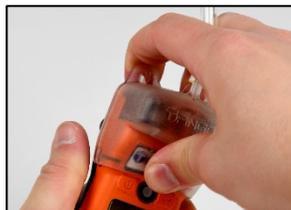
Para eliminar el recipiente de calibración, levante las pestañas del recipiente. Deje a un lado o guarde para usar en el futuro.
