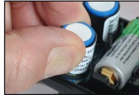
Fije el sensor ejerciendo una presión suave en los lados de la caja del sensor. No toque la membrana blanca del sensor. Podrá sentir un impacto de conexión ligero cuando se fija el sensor en posición.
