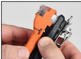
Baje el ensamblaje de la parte superior de la carcasa en dirección a la parte inferior. Realice un movimiento descendente y recto para llevar los sensores a los barriles para sensores.
