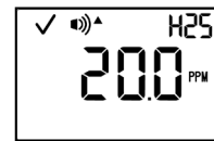
Seuil d'alarme haute
