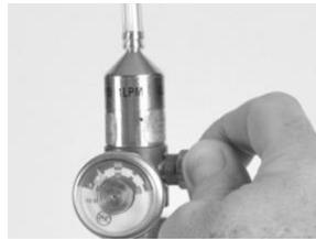
Arrêtez le flux de gaz : tournez le bouton du détendeur dans le sens des aiguilles d'une montre et serrez.
