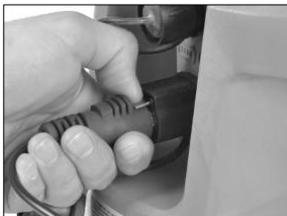
Lorsque la charge est terminée, appuyez sur la languette du connecteur du cordon d'alimentation et tirez pour débrancher le cordon d'alimentation de l'instrument.
