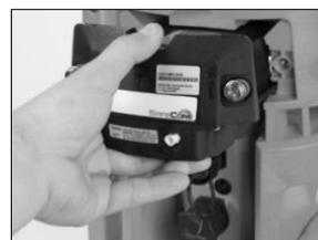
Pour retirer le module de la balise, tirez-le à l'horizontale. Veillez à ne pas endommager les broches du connecteur du module.
