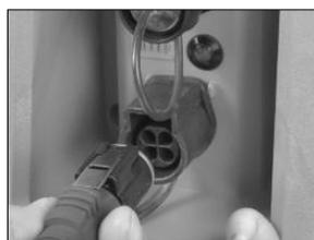
Insérez le cordon d'alimentation dans le port de charge avec la languette métallique vers le haut. Lorsqu'il est totalement inséré, la languette s'enclenche avec un déclic.
