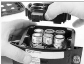
En tenant le collier pour cellules par les bords, alignez-le et déposez-le dans le module.
