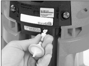
Branchez le filtre hydrophobe sur la prise d'air et tournez dans le sens des aiguilles d'une montre pour serrer.
