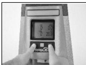
Pour accéder aux paramètres, appuyez sur les boutons gauche et droit simultanément et maintenez-les enfoncés.
