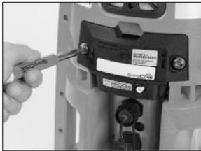
En utilisant le jeu de tournevis fourni, serrez les deux vis de fixation du module. Poussez la vis dans le trou ; le ressort se comprime. Tournez la vis dans le sens des aiguilles d'une montre ; serrez jusqu'à ce que l'indicateur rouge entourant le trou ne soit plus visible.
