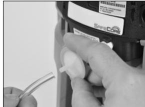
Raccordez une extrémité du tube de prélèvement au filtre externe qui est fixé sur la prise d'air (ci-dessus à gauche).
