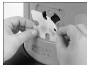
Alignez le nouveau filtre antipoussière, côté adhésif tourné vers la balise, sur les rainures correspondantes du boîtier. Pour un positionnement correct, veillez à ce que les encoches sur les bords du filtre coïncident avec les encoches de l'ouverture.
