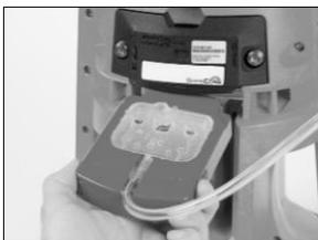
Retirez la coiffe d'étalonnage du circuit de gaz : faites-la glisser hors de l'instrument et mettez-la de côté pour une utilisation ultérieure.
