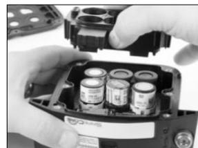
En tenant le collier pour cellules par les bords, soulevez-le pour le retirer et mettez-le de côté pour le remontage ultérieur.
