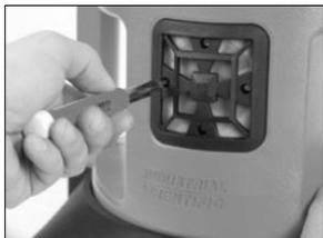
Utilisez le jeu de tournevis fourni pour retirer les quatre vis de la grille de haut-parleur. Mettez les vis de côté.
