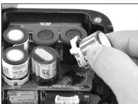
Positionnez la nouvelle cellule de manière à l'aligner sur les connecteurs du circuit imprimé.
