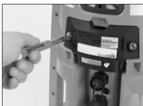
Utilisez le jeu de tournevis fourni pour desserrer les deux vis de fixation imperdables à l'arrière du SafeCore Module. Pour retirer et remplacer les vis, utilisez le kit de vis du SafeCore Module.
