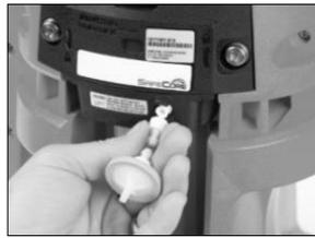
Alignez le filtre hydrophobe de rechange sur la prise d'air et tournez dans le sens des aiguilles d'une montre pour serrer.
