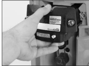
Glissez le module dans le port. Appuyez fermement pour connecter le module à la balise. Veillez à ne pas endommager les broches du connecteur du module.
