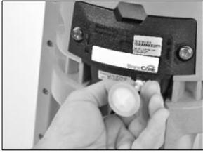
Saisissez le filtre hydrophobe par le connecteur. Tournez-le dans le sens inverse des aiguilles d'une montre et tirez pour le retirer.
