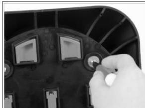
En utilisant le jeu de tournevis et l'embout T20 livré avec le nouveau sabot, retirez et jetez les vis qui fixent le sabot au reste du Radius Base.
