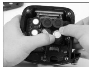
Placez la cellule sur le circuit imprimé. Appliquez une légère pression sur le pourtour de la cellule. Si elle est installée correctement, vous entendrez un déclic à la fixation de chaque connecteur de la cellule sur le circuit imprimé.
