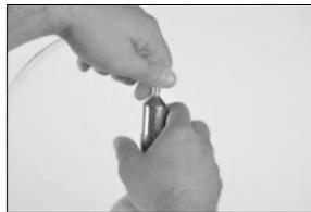
Connectez l'une des extrémités du tube d'étalonnage au raccord du détendeur.
