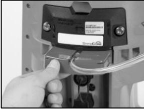
Pour les appareils à diffusion (illustration), glissez la coiffe d'étalonnage dans le circuit de gaz. Appuyez fermement et vérifiez que le bord de la coiffe d'étalonnage affleure à la surface du SafeCore Module. Pour les appareils à aspiration, reliez le tube d'étalonnage à la prise d'air.
