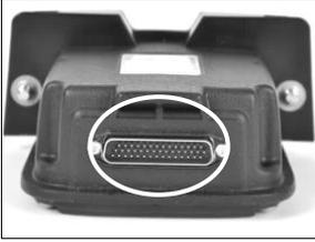
Procédez à une inspection visuelle du connecteur du SafeCore Module (entouré) en vérifiant qu'il est exempt de saletés et de débris. Nettoyez à l'air comprimé si nécessaire.
