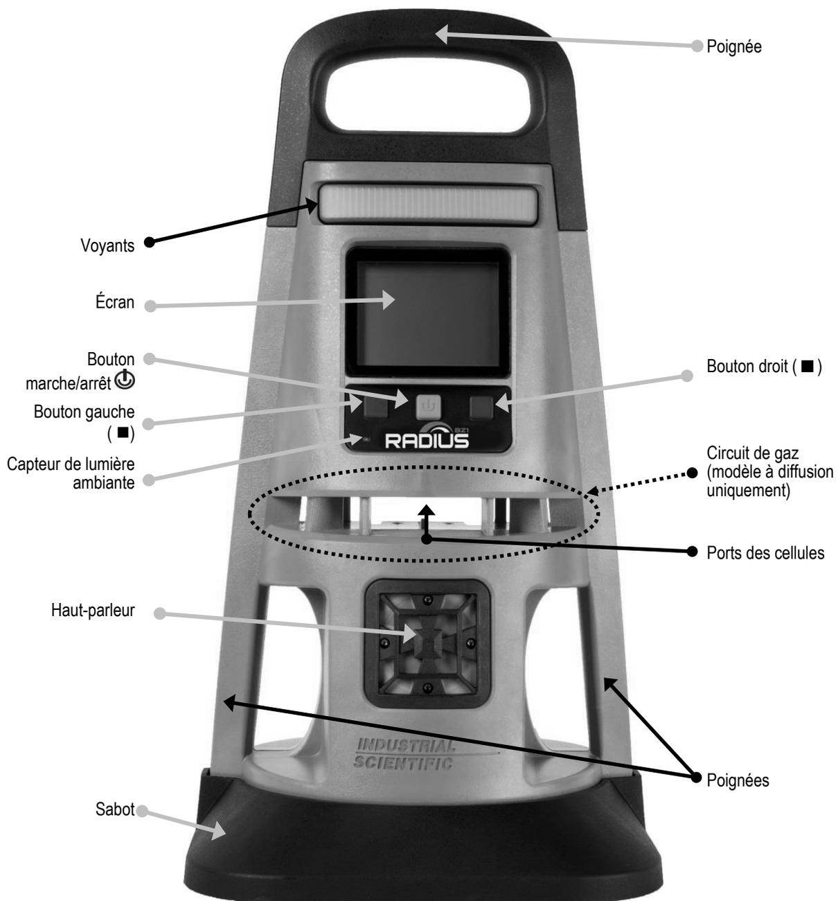
Figure 3.1.A Présentation des composants du Radius BZ1 (vue avant, modèle à diffusion)
