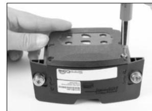
En utilisant le jeu de tournevis, insérez et serrez les six vis du couvercle de module. Consultez le Tableau 8.1 pour connaître les valeurs de couple.
