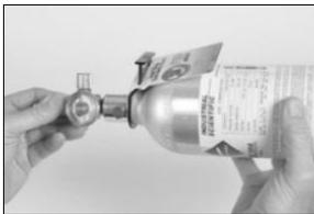
Tout en tenant le détendeur (à débit positif ici), tournez la bouteille de gaz d'étalonnage dans le sens des aiguilles d'une montre pour serrer.
