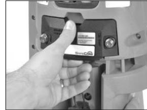
Un léger dé clic à la connexion et l'alignement du module sur la balise indiquent que le module est installé correctement.
