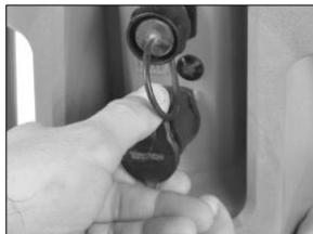
Remettez le capuchon de protection du port en place avant d'utiliser l'instrument dans une zone classée dangereuse pour laquelle il est certifié.
