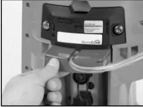
Pour les appareils à diffusion (illustration), glissez la coiffe d'étalonnage dans le circuit de gaz. Appuyez fermement et vérifiez que le bord de la coiffe d'étalonnage affleure à la surface du SafeCore Module.
