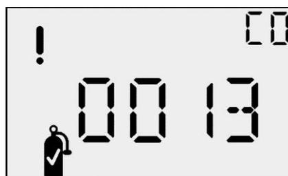
Tela de falha de calibração
