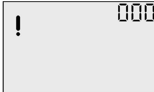
Pantalla de error por falta de sensor
