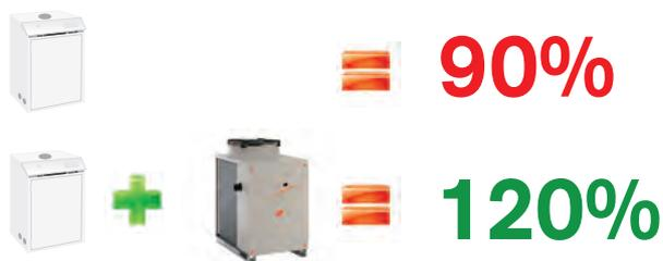
Тепловые насосы ГАНР наилучшим способом дополняют котлы, так как, благодаря их КПД, превышающему на 40% аналогичный показатель лучших конденсационных котлов, они повышают общий КПД системы. Таким образом, каждый год они обеспечивают значительную экономию затрат на отопление (в рисунке рядом показан вариант для системы, где тепловая мощность ТН равна 50% общей мощности системы).
