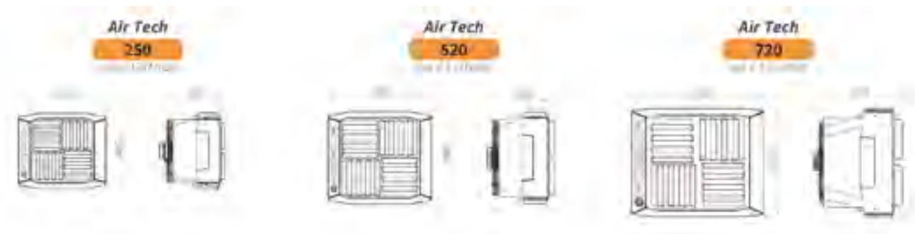
Sono disponibili 3 modelli di Destratificatori Robur Air Tech. Ogni unità ha una portata d'aria diversa, in grado di garantire un elevato comfort in base alle diverse altezze dell'edificio. (F.1)
