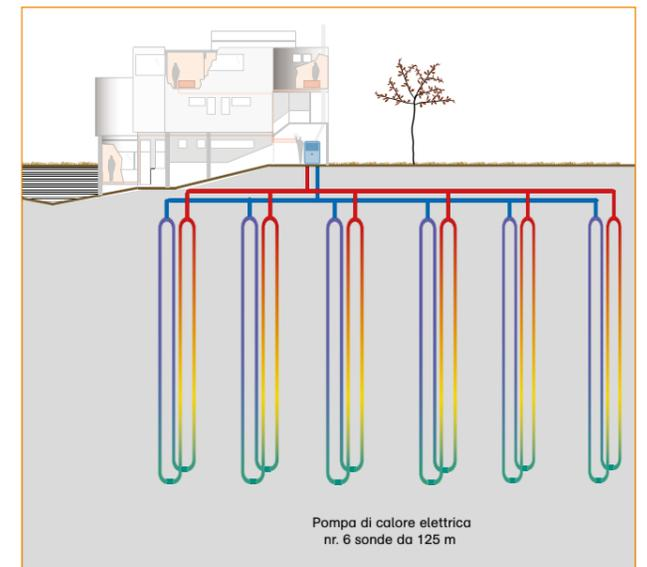
Esempio indicativo di applicazione di impianto di riscaldamento geotermico da circa 40 kW.
