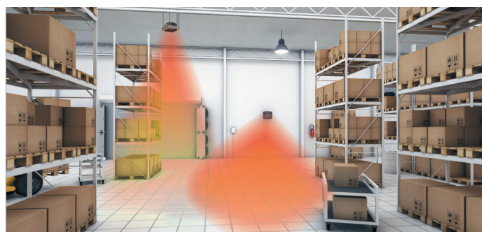
Fase2 - attivazione degli aerotermi per raggiungere il livello di temperatura impostato dall'utente
