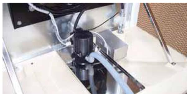
Figura 5.3 Dispositivo automatico di lavaggio e svuotamento
