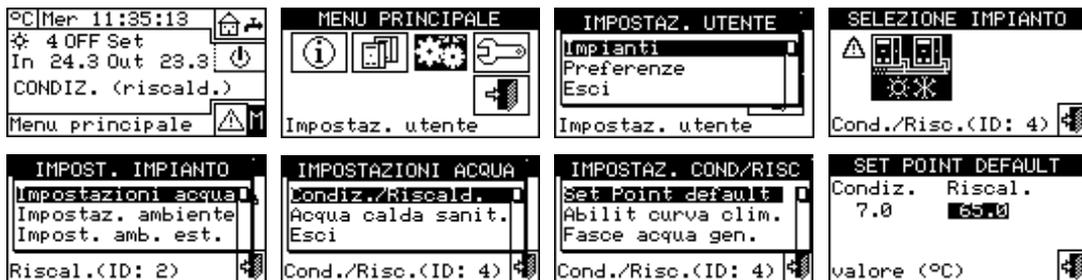
All'interno della schermata compaiono le temperature di setpoint dell'acqua per il funzionamento in condizionamento e/o riscaldamento a seconda del tipo di impianto configurato.
