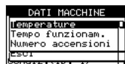
Si ha una panoramica di tutte le temperature di funzionamento della macchina selezionata il cui ID è indicato tra . Per visualizzare le temperature di funzionamento di un'altra unità selezionare .
