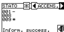
Selezionare per visualizzare le unità in errore o in warning. Se la macchina è in errore a fianco all'ID dell'unità comparirà E.
