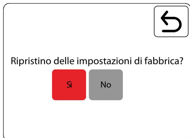
Una volta ripristinate le impostazioni di fabbrica, andrà eseguita nuovamente l'impostazione del comando centralizzato Air Box, come descritto nel Paragrafo 4.2 p. 8.
