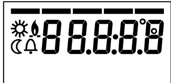
Beim Einschalten zeigt das Display für einige Sekunden alle verfügbaren Segmente an.
