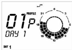
5. Auf dem Display oben rechts erscheint die Anzeige PROFILE und die Nummer des gewählten Profils blinkt (Abbildung 6.5 S. 30).
