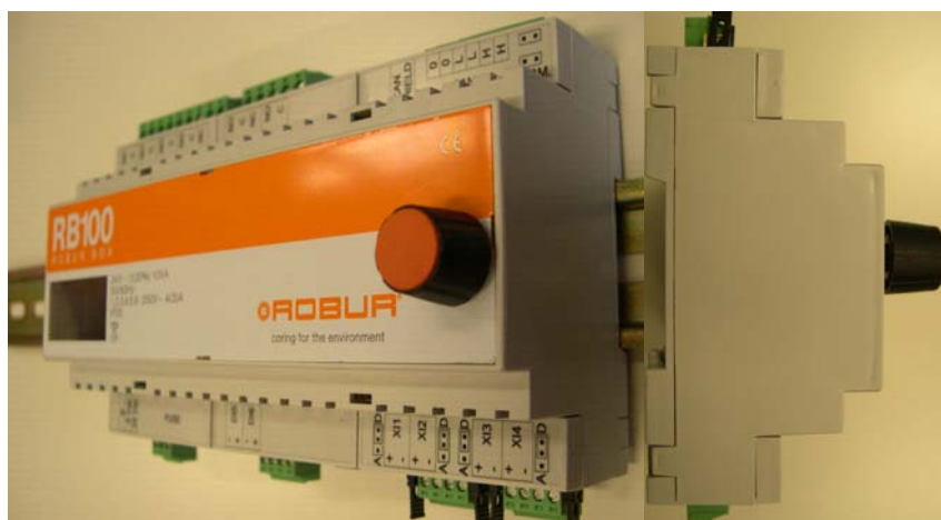
Figure 3 Appliance installation on DIN guide (EN 60715)
