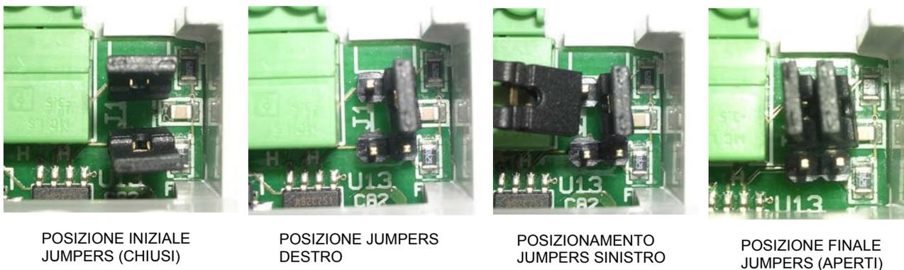
**Figura 25** NODO INTERMEDIO: in evidenza la posizione consigliata per i jumpers APERTI.
