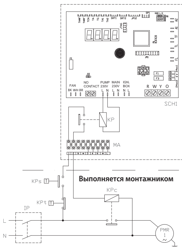
Рисунок 4.7 Электрическая схема соединения насоса рекуператора
