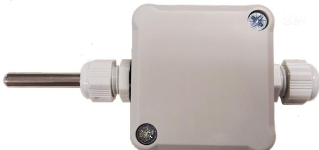
La sonda di temperatura PT1000 è una sonda di temperatura di tipo resistivo con elemento sensibile in platino e resistenza pari a 1000 Ω alla temperatura di 0 °C, corredata di scatola di installazione idonea per il fissaggio a muro.
