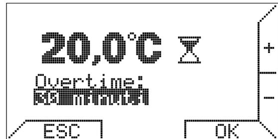
Concluso il tempo di durata della funzione overtime il cronotermostato si posiziona nel modo di funzionamento automatico.
