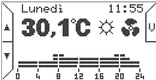
All'occorrenza è possibile forzare la ventilazione estiva tramite l'apposito tasto V posto in alto a destra. Una volta forzata la ventilazione il tasto V viene evidenziato, sul display compare la scritta "Vent. forzata" e scompare la visualizzazione delle fasce orarie, come rappresentato in Figura 5.8 p. 4.
