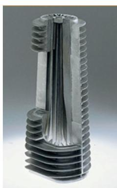
Risultato: su un'altezza di circa 30 cm la differenza di temperatura di contatto tra la base e la testa è di circa 50 °C, proprio perché i fumi di combustione in ingresso nella parte bassa vengono rapidamente raffreddati mentre salgono nello scambiatore (Figura 2.4 p. 2). Questa differenza di temperatura sullo scambiatore si ripercuote positivamente sul flusso d'aria che investe lo scambiatore: questa risulta infatti più calda nella parte inferiore rispetto a quella nella parte superiore.
