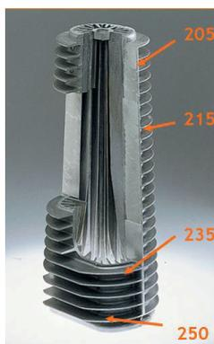
Anche la realizzazione della forma tronco-conica dello scambiatore accentua questa differenza: nella parte alta della finestra di attraversamento dell'aria di ventilazione, l'alettatura è meno fitta, quindi consente il passaggio di più aria che nella parte inferiore.
