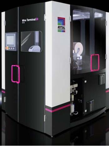
Mit dem neuen kompakten Drahtkonfektioniervollautomaten Wire Terminal WT können bis zu 36 unterschiedliche Drähte in den Querschnitten von 0,5 mm<sup>2</sup> bis 2,5 mm<sup>2</sup> ohne manuellen Eingriff vollautomatisiert produziert werden.
