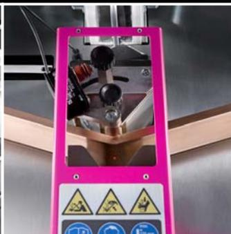
Stanzen von Stromschienen, ausziehbares Messsystem
