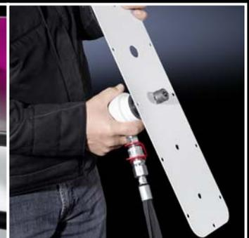
Einbringen von Ausbrüchen in Stahl und Edelstahl (Zubehör Hydraulikschlauch und -zylinder, siehe Seite 39)
