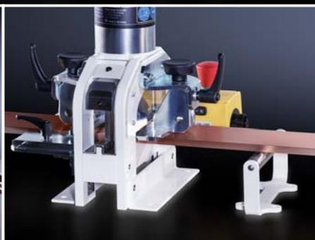
Ablängen einer Stromschiene
