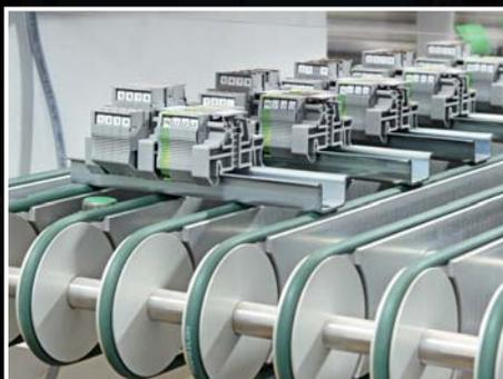
Sortiereinheit und Pufferlager für bearbeitete Klemmenleisten
