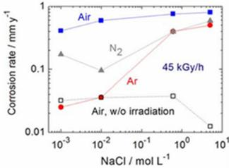
大気開放ならびに Ar ガス, 高純度 N<sub>2</sub> ガス雰囲気での、濃度の異なる NaCl 水溶液中での腐食速度。破線は大気開放・非照射下での速度。(45 kGy/h, 室温, 3 日間浸漬)
