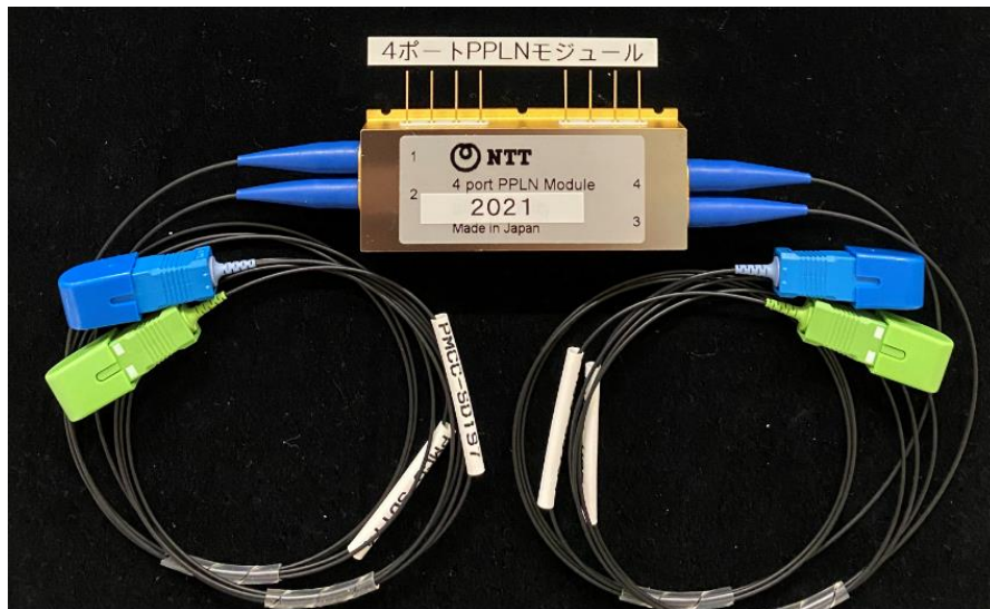
図3 今回開発したファイバ接続型の非線形光学デバイス
