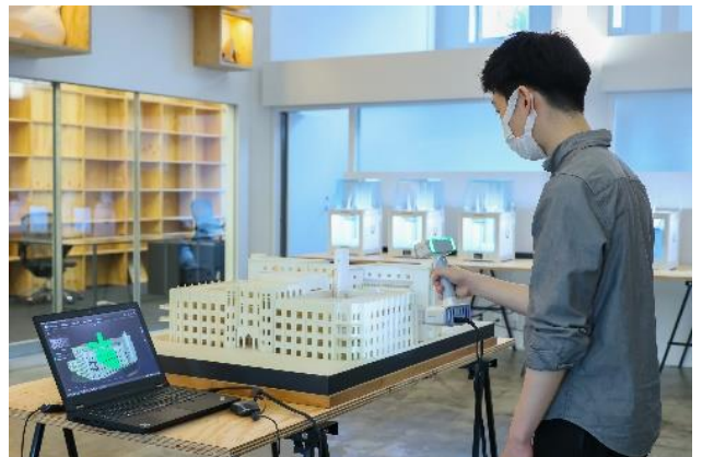
3D スキャナで建築模型を デジタルアーカイブする様子
