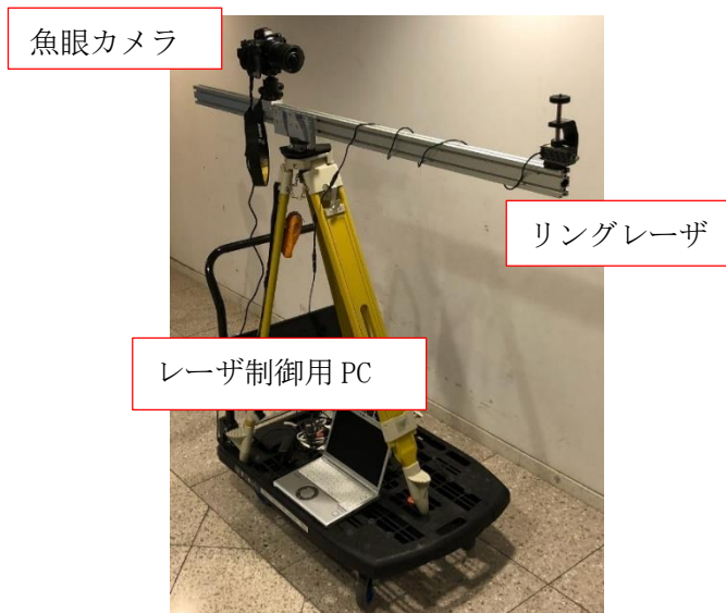
写真3 山岳トンネル断面計測システム
