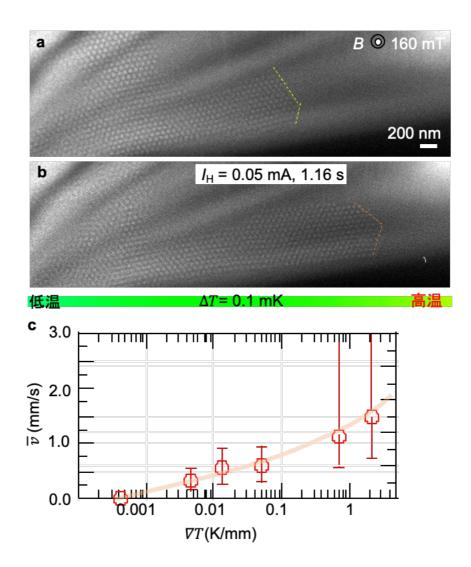
図2 スキルミオン駆動速度の温度勾配依存性
