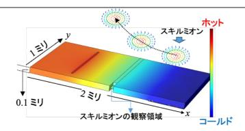
微小熱流によってスキルミオンが試料の高温側に駆動する仕組みの模式図
