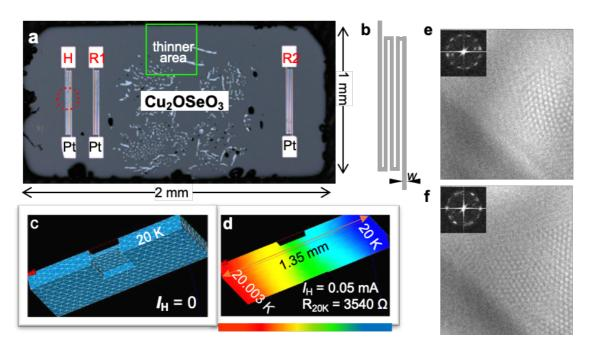
図3 熱流を反転したときのスキルミオン駆動の顕微鏡観察
