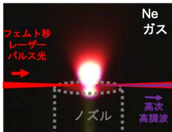
共振器内の集光点に吹き付けたネオン（Ne）ガスからの発光
