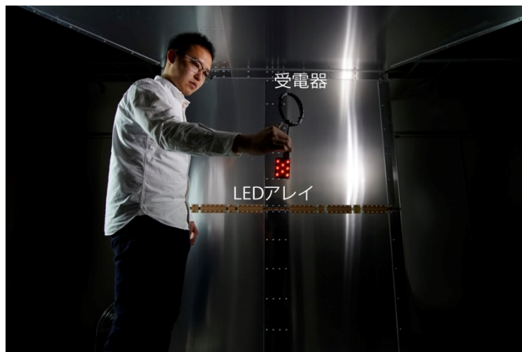
図 4 : 部屋内の電子機器へのワイヤレス充電の例
