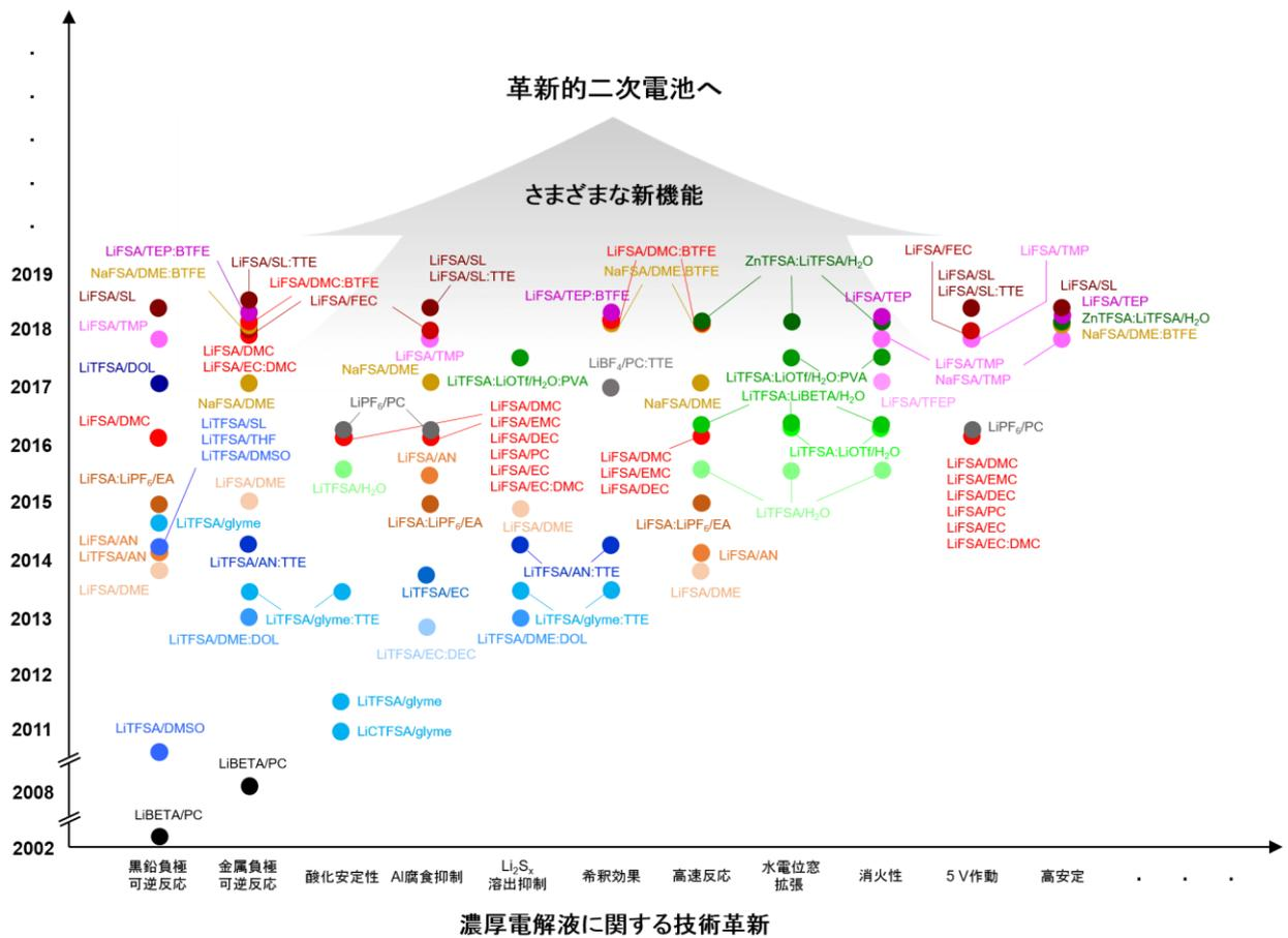
図3 濃厚塩領域における溶液科学は古くから研究されているが、電解液としての新機能・超機能の探索と発見は2014年以降に集中しており、現在も報告が相次いでいる。短期間で実現されてきた機能は多岐に渡り、複数の機能をバランス良く高度に同時実現する系も散見されるようになってきた。特に、超高速充放電、5V級高電圧耐性、消火機能、長期安定動作といった従来得られなかった大きな付加価値は、先進蓄電池の開発と社会実装を加速する原動力になり得ると期待されている。
