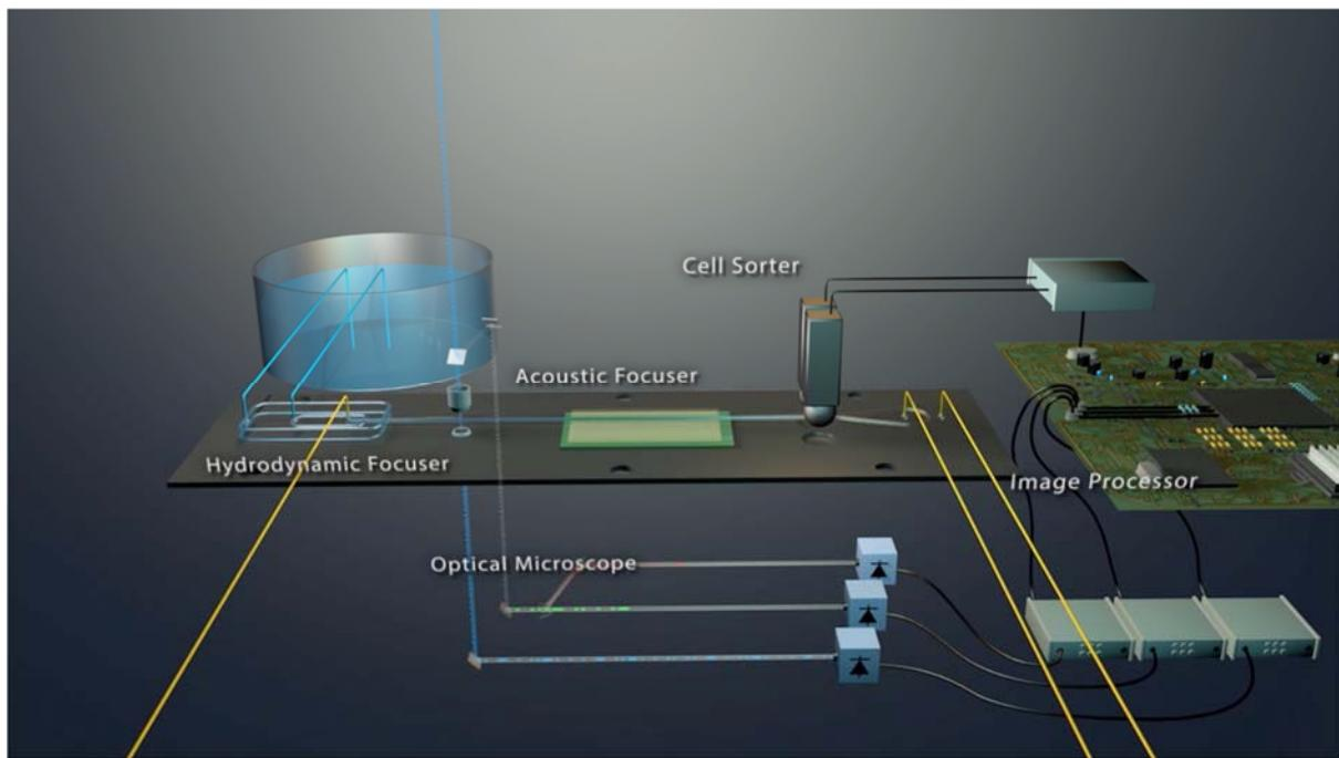
動画1. 本技術の機能。超高速蛍光イメージング技術、10 ギガビットイーサーネットによる高速データ処理システム、マイクロ流体技術を活用した高速分取技術や細胞制御技術など、複数分野にまたがる異分野融合により実現しました。
