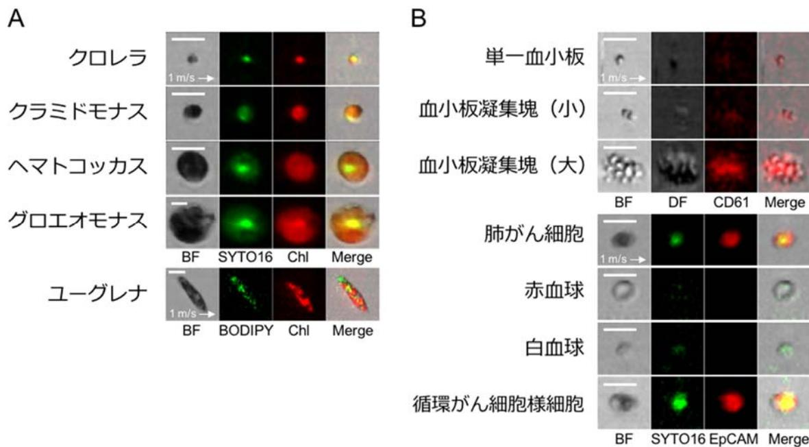
図 2. 本技術の汎用性実証のための撮像例。3マイクロメートルから30マイクロメートル程度にわたる様々な大きさや形の異なる細胞を高速撮像しました。A. 微細藻類の観察。B. 血液に含まれる細胞の観察。BFは明視野、SYTO16は核染色による蛍光、BODIPYは油滴染色による蛍光、Chlはクロロフィルの自家蛍光、DFは暗視野、CD61は血小板表面染色による蛍光、EpCAMはがん細胞表面染色による蛍光のイメージを示します。循環がん細胞様細胞はがん患者の血液から撮像しました。
