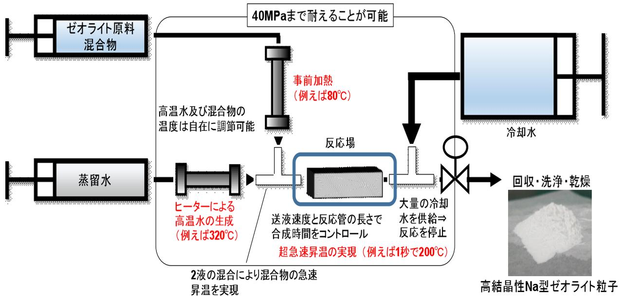
図2 二液混合型流通合成システム
