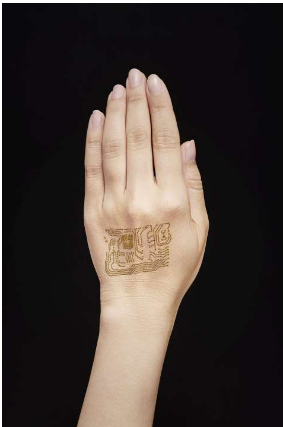
提供写真2 皮膚貼り付け型ナノメッシュ電極を手の甲に装着した。皮膚の形状にもピッタリと沿って貼り付いている。極薄で超軽量であり、自然な皮膚呼吸が実現されているため、装着感がない。
