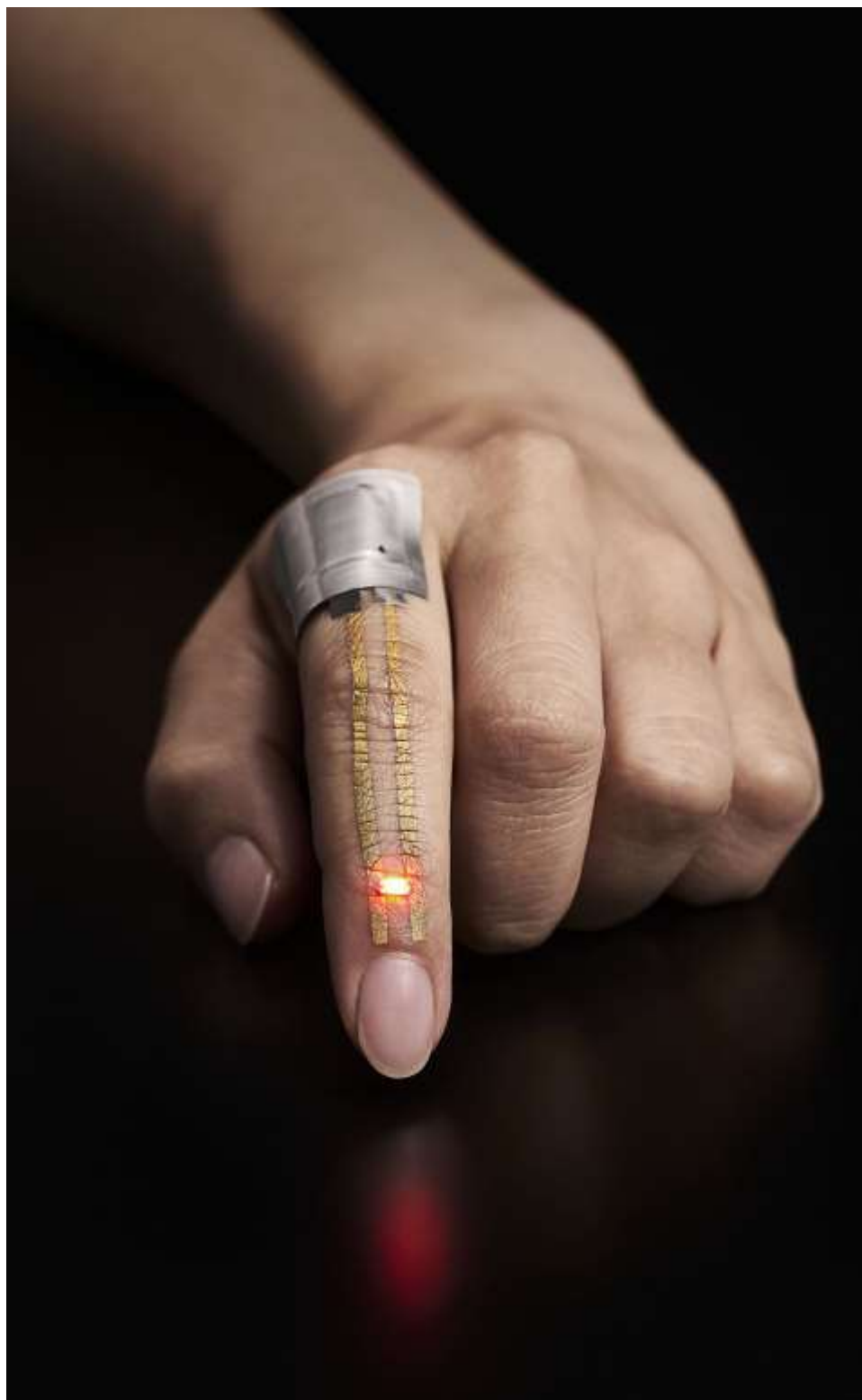
提供写真1 皮膚貼り付け型ナノメッシュ電極を人差し指に装着し、フレキシブルバッテリーから電力を供給して発光ダイオードを点灯させた。
