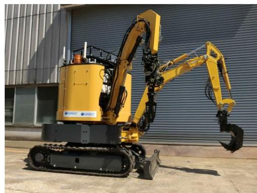
図1 2重旋回・複腕ロボット
