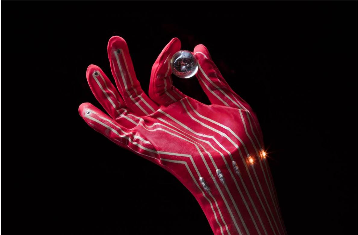
図5 手袋の指先に実装されたセンサーで指先の圧力の強さを計測し、その強さに応じてLEDの点灯強度が変わる。画像データではわからない力の入れ具合を知ることができる。
