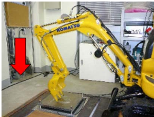
図4 神戸大の実験機での鉛直押付け実験の様子
