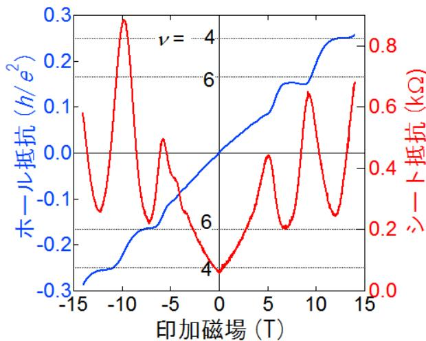
図2 デルタドープ  $\text{SrTiO}_3$  構造でみられた整数（偶数）量子ホール効果
