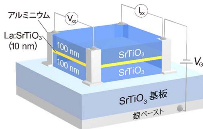
図 1 デルタドープ SrTiO<sub>3</sub> 構造における電気特性測定の模式図
