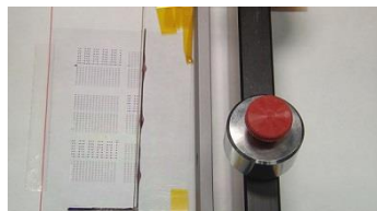
スーパーナップ法による金属配線の印刷製造工程の一部 (左) とフレキシブル基板 (右)
