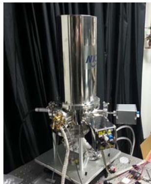
図4: NICT開発の超伝導光子検出器(SSPD)
